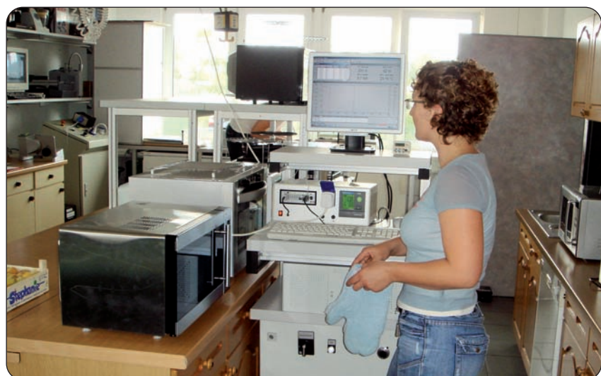
Bild 2: Eine Mitarbeiterin testet in einer Mikrowelle mit Grillfunktion wie das Gerät toastet, also wie z. B. der Bräunungsgrad ausfällt
