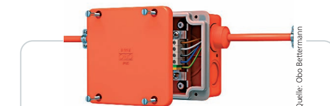
Bild 1: Der Kabelabzweigkasten ermöglicht das Verlängern und Abzweigen von sicherheitsrelevanten Kabeln in einer Kabelanlage mit integriertem Funktionserhalt nach DIN 4102 Teil 12
